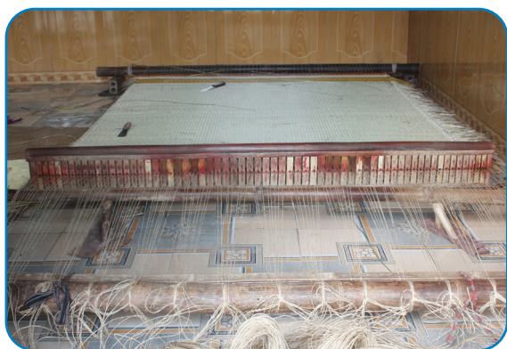
Hình 5.13. Dệt chiếu thủ công
